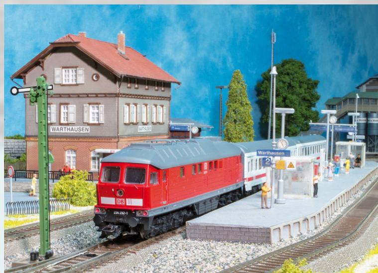
Klarer Fall: Der Flügel des Hauptsignals zeigt waagrecht nach rechts – der Haltebefehl für den Lokführer.
