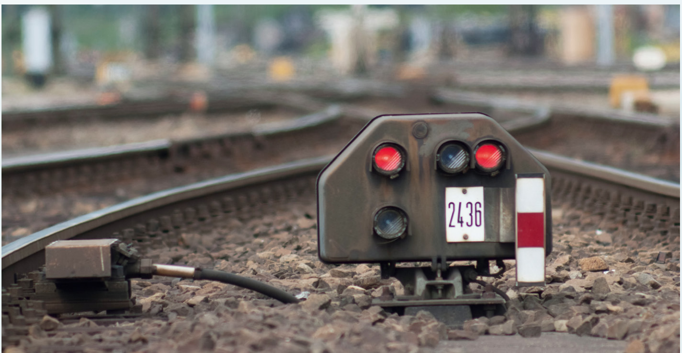
Ein Gleisperrsignal, das den Rangierverkehr regelt – zu finden ist es daher im Vorbildbetrieb nur im Bahnhofsbereich. Das gilt natürlich auch für die Aufstellung auf der Modellbahn.
