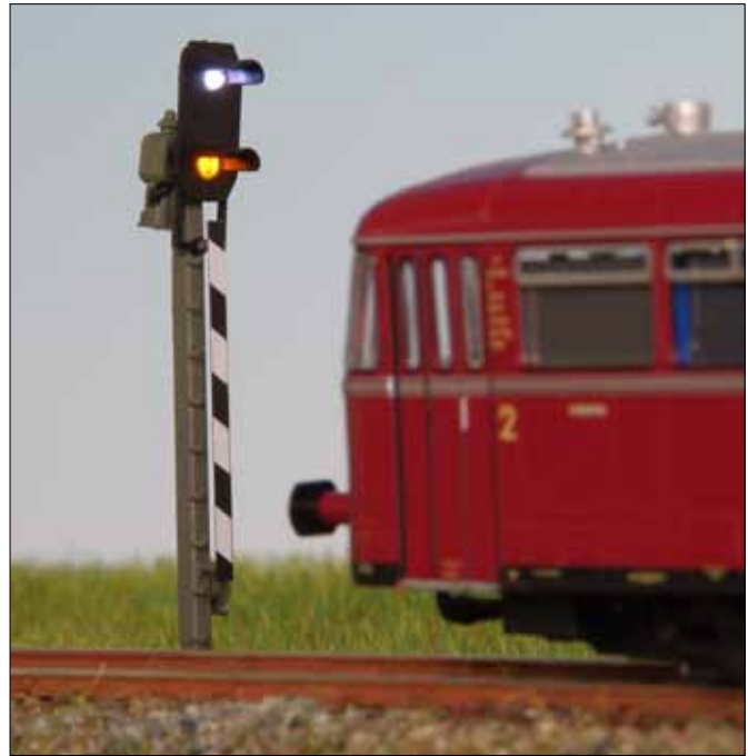
Das gelbe Licht am Blinklicht-Überwachungssignal ist immer eingeschaltet, das obere Licht blinkt bei korrekter Funktion der Andreaskreuze.
