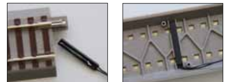
Beim Roco H0-GeoLine Gleis sind angepasste Reed-Kontakte in Aussparungen einsetzbar.
