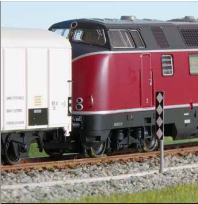
Eine Eigenkreation ist die Rautentafel, die dem Lokführer das Blinklicht-Überwachungssignal ankündigt.
