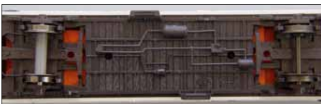
Eine Achse mit Widerstand als Verbraucher. Produkt von Roco. Rechts: Ebenso kann ein Widerstandslack Verwendung finden.
