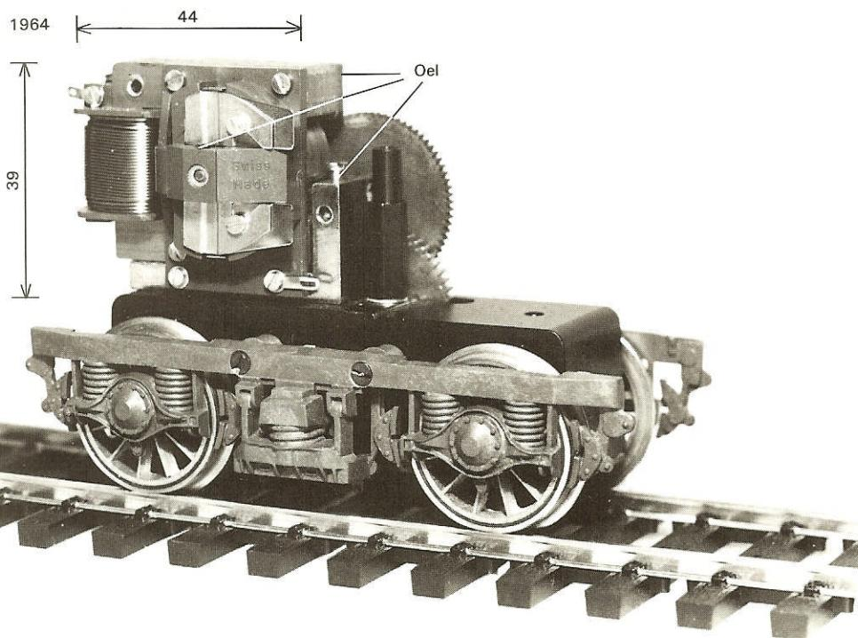
Alle meine Triebfahrzeuge sind mit dem speziell für die Spur 0 entwickelten Motor ausgerüstet. Betriebsspannung 18 Volt. 5polig, 0,6 Ampères. Der Rotor ist in Sintermetall gelagert.
